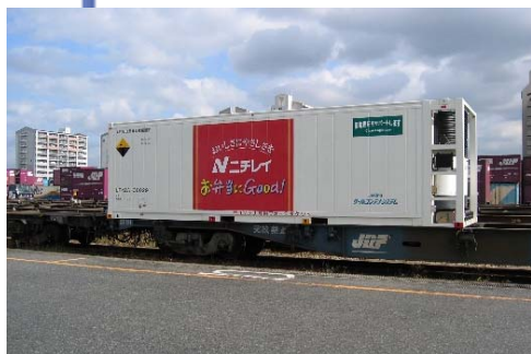
図1 東京⇄福岡で使用していた 31フィート冷凍コンテナ
